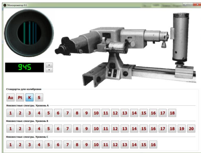
Рис. 2. Внешний вид экспериментальной установки и программы-симулятора «Монохроматор 0.1»
