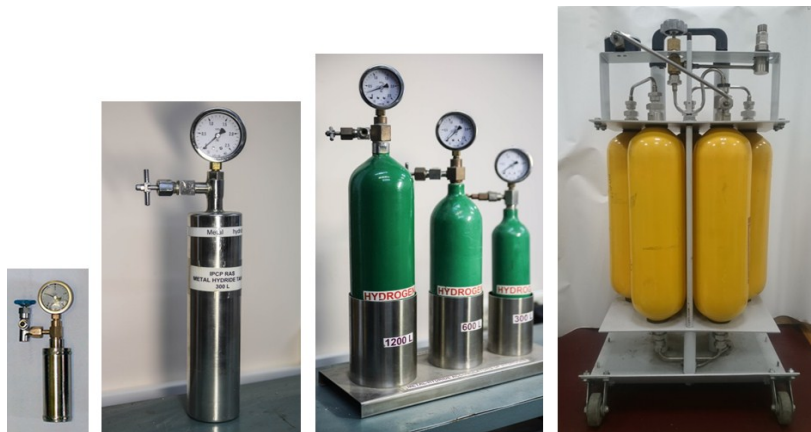
Рис. МГ аккумуляторы водорода, разработанные в Комплексе лабораторий водородного материаловедения ФИЦ ПХФ и МХ РАН
