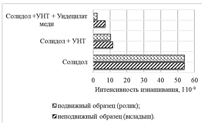
Рис. 1. Зависимость интенсивности изнашивания образцов при использовании смазочных композиций синтетического солидола марки С с добавками УНТ и ундецилата меди
