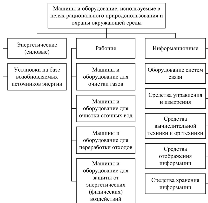
Рис. 1. Систематизация машин и оборудования, используемых в целях рационального природопользования и охраны окружающей среды (составлено автором)
